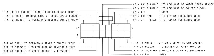
16 - PIN CONNECTOR AT CONTROLLER
